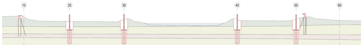
Abbildung 25: Bauphase 1: Herstellung der Pfeiler [01-6_Installationsplan]
