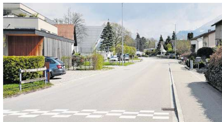
Auf der Nöllenstrasse führen Verlangsamungen mit sogenannten Knotenanhebungen zu einer Geschwindigkeitsreduktion um etwa 5 km/h.
